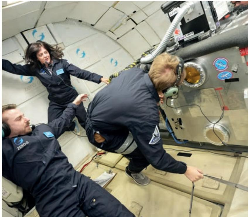
Los ingenieros y científicos de la NASA Marshall, junto con sus colaboradores de la Universidad Estatal de Ohio, supervisan la soldadura con haz láser en una cámara de vacío durante un vuelo parabólico de un Boeing 727. (Imagen: NASA)
