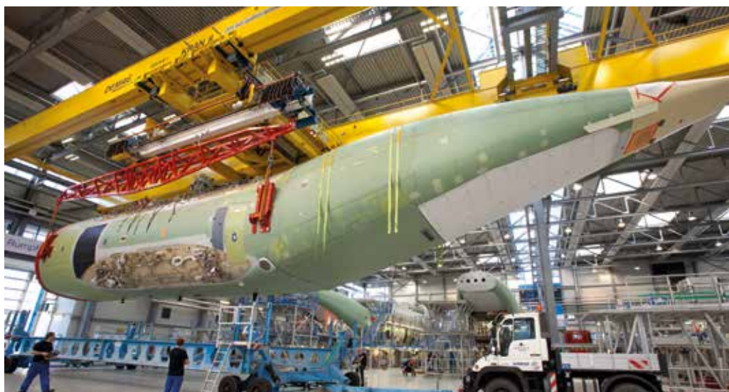
Bremen: Ein vollständig montierter Rumpf wird in die Hallenmitte auf einen Wagen gehoben und in die Beluga-Halle nebenan gebracht. Das Frachtflugzeug wird ihn nach Sevilla bringen.
