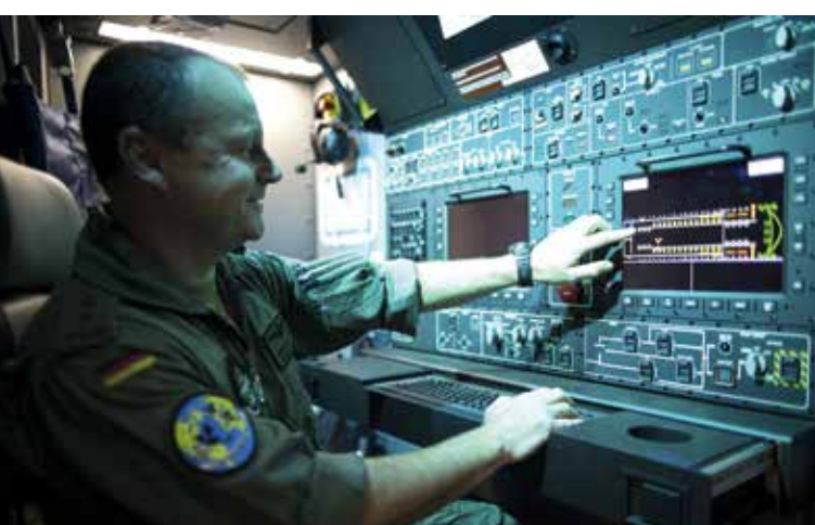
Hauptmann Norbert erläutert die Arbeit an der Loadmaster Working Station, dem Bindeglied zum Computer-Netzwerk der A400M.
