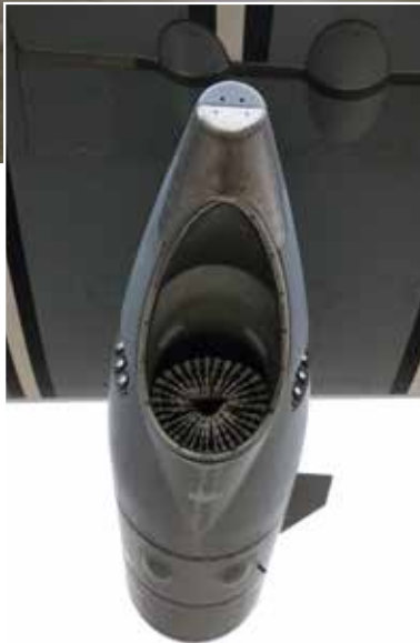
Der Betankungspod mit dem markanten Drahtgeflecht, das sich im Luftstrom zu einem Trichter entfaltet.
