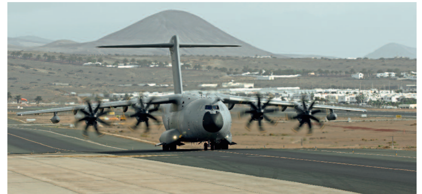
↓ La taille impressionnante des hélices de cet A400M espagnol au roulage à Lanzarote donne une idée des performances élevées du quadrimoteur, véritable couteau suisse du transport aérien militaire européen. Les nacelles de ravitaillement en vol sont visibles sous les points extérieurs de voilure.
